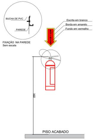
DETALHE - EXTINTOR DE INCÊNDIO EM PAREDE E SUA FIXAÇÃO Sem escala
